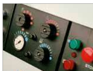
PANEL DE CONTROL CON APAGADO DE EMERGENCIA
